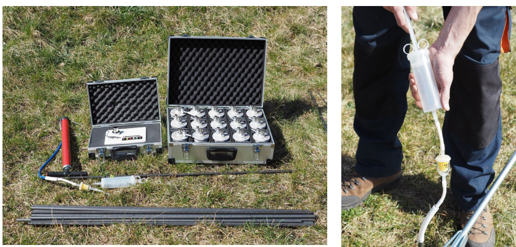
Obrázek 2 Měřicí systém RM-2, odběrové tyče, podtlaková pumpička, velkoobjemová stříkačka, filtr a gumového napojení (vlevo), detail velkoobjemové stříkačky, filtru a gumového napojení na odběrovou tyč (vpravo)
